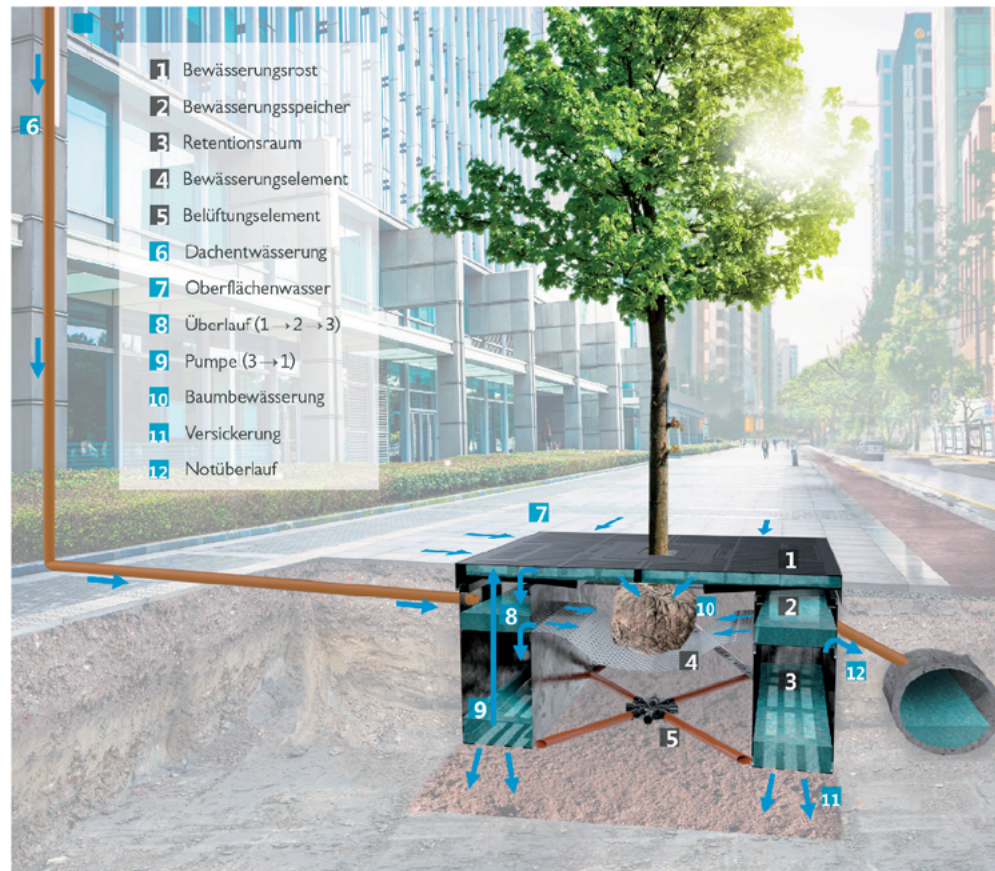
Abb. 1: Prinzipskizze des Baumrigolensystems Alveus (Fa. Humberg) | Foto: Humberg GmbH, FH Münster
