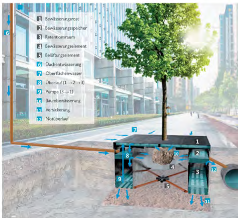
Abb. 1: Prinzipskizze des Baumrigolensystems Alveus (Fa. Humberg) | Foto: Humberg GmbH, FH Münster
