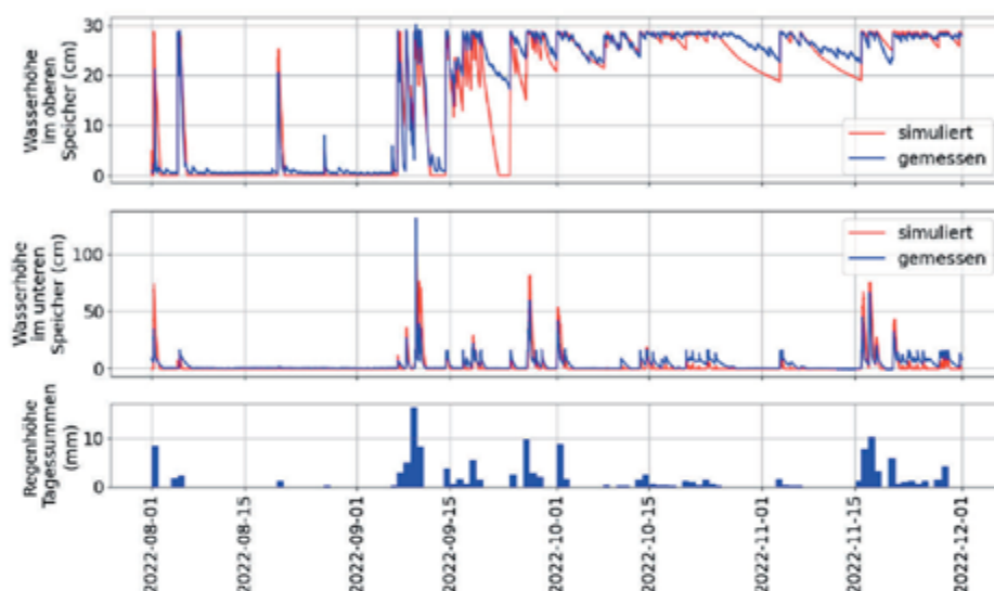
Abbildung 4: Vergleich des Simulationsergebnisses mit gemessenen Werten für die Wasserhöhen im oberen und unteren Speicher während eines Kalibrierungszeitraumes. | Foto: Grüning, FH Münster
